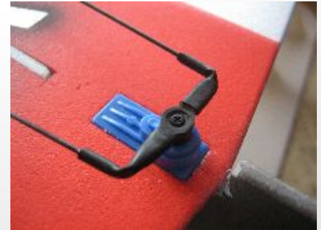
Anlenkung der Querruder. Hier noch ohne Servohebelverlängerung und dafür mit gekürzten Ruderhörnern.
